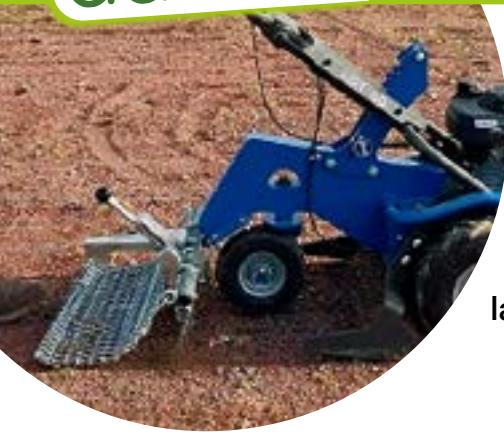
Le rabot de piste est un outil permettant simultanément le désherbage, le ratissage, et une finition de surface. Tout d'abord, une double rangée de lames ou de disques s'enfonce dans le sol sur quelques centimètres, arrache la « mauvaise herbe » (la partie aérienne et la racine) et décompacte le sol superficiellement. Ensuite, une lame nivelle. Enfin les griffes ratissent les déchets et affinent la surface.
