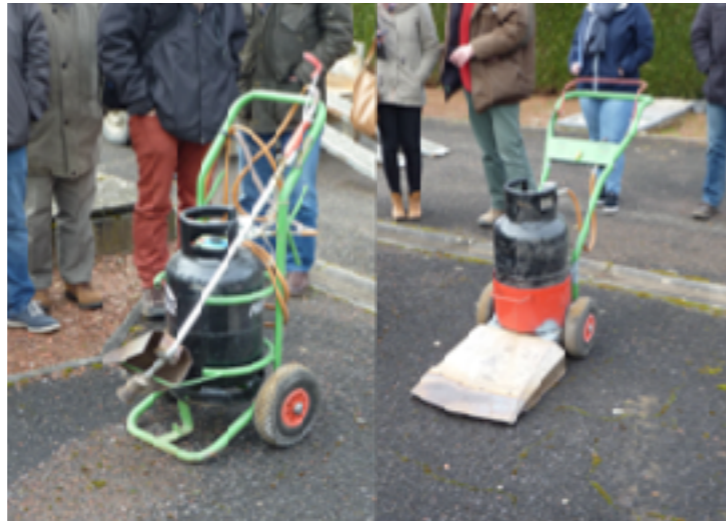
Désherbeurs thermiques, pour les grandes surfaces (à gauche) et pour les espaces difficiles d'entretien (à droite)
