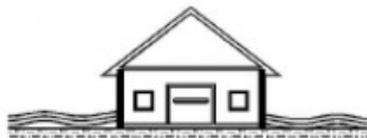
**Etanchéification externe** empêchant l'eau de pénétrer dans le bâtiment (dry waterproofing)
