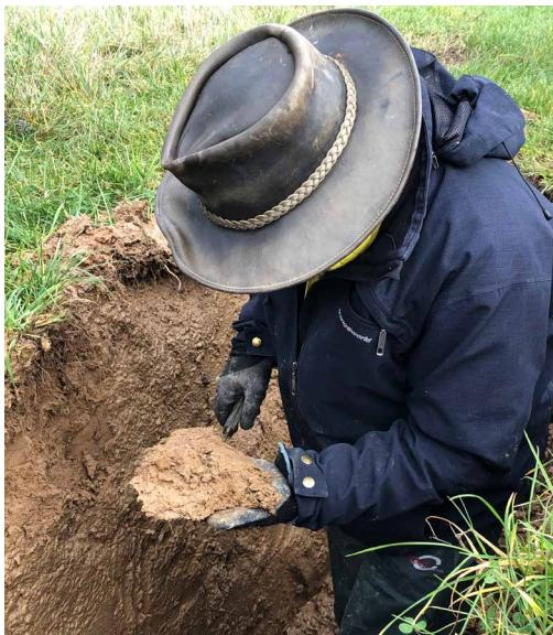
Le prélèvement d'échantillons de sols peut être effectué dans une fosse pédologique – Grez-Doiceau 2019 © P. Colomb
