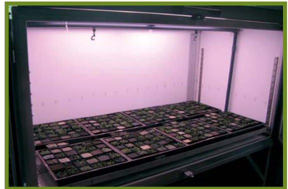
Figure 10 – Essai en pot dans une enceinte climatique
