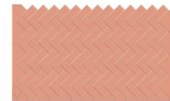
Appareillage à bâtons rompus
