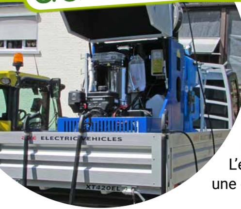
La technique à l'eau chaude consiste à appliquer sur les «mauvaises herbes» de l'eau proche de 90°C, ce qui provoque l'éclatement des cellules des végétaux et la dénaturation des protéines. Ce procédé cible uniquement les parties aériennes des végétaux, les racines ne sont ainsi pas touchées. Cette technique est efficace sur de jeunes stades foliaires, c'est à dire 3 à 4 feuilles. Si le stade foliaire est plus avancé, le temps d'application sera plus important.
