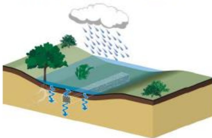
Figure 4 - Noue infiltrante avec enrochement linéaire en son point bas afin de limiter l'apparition de flaque. Ce massif n'est pas drainé par une évacuation vers un exutoire mais permet de stocker temporairement une partie des eaux de ruissellement. Toute l'eau stockée dans la noue et son enrochement sera ensuite infiltrée dans le sol. Source Architecture & Climat.
