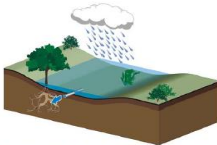
Figure 5 - Noue à évacuation superficielle. Le sol est très peu perméable. Les eaux stockées sont évacuées à débit régulé vers un exutoire via un orifice au pied de la noue. Cet orifice doit être très régulièrement entretenu pour éviter toute obstruction. Source Architecture & Climat.
