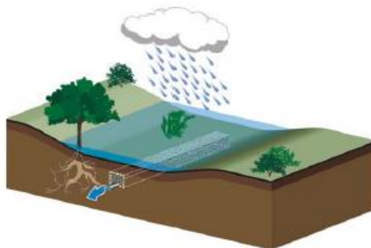
Figure 6 - Noue drainante sur un sol très peu perméable. Les eaux stockées dans la noue s'infiltrent dans le substrat superficiel et sont drainées dans un massif qui évacue les eaux à débit régulé vers un exutoire. Source Architecture & Climat.
