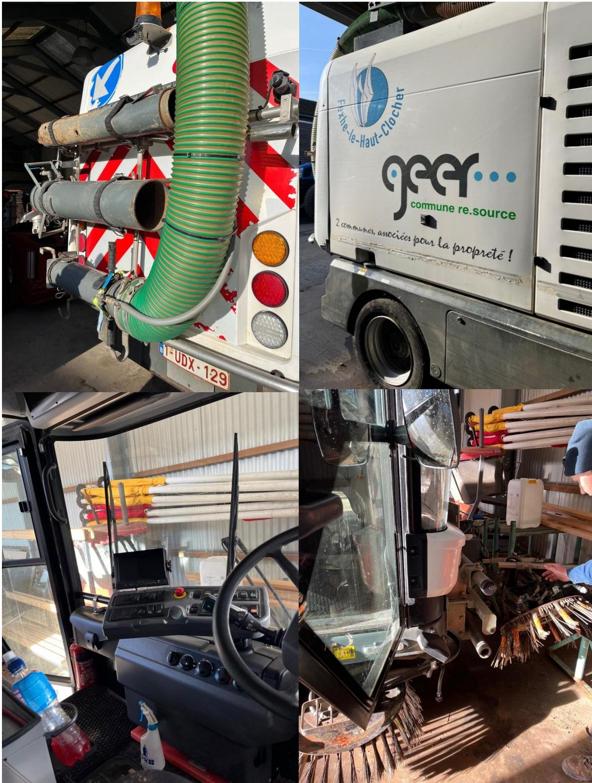
Figure 13 : photos de la balayeuse équipée d'un bras de désherbage, mutualisée par les communes de Fexhe-le-Haut-Clocher et Geer
