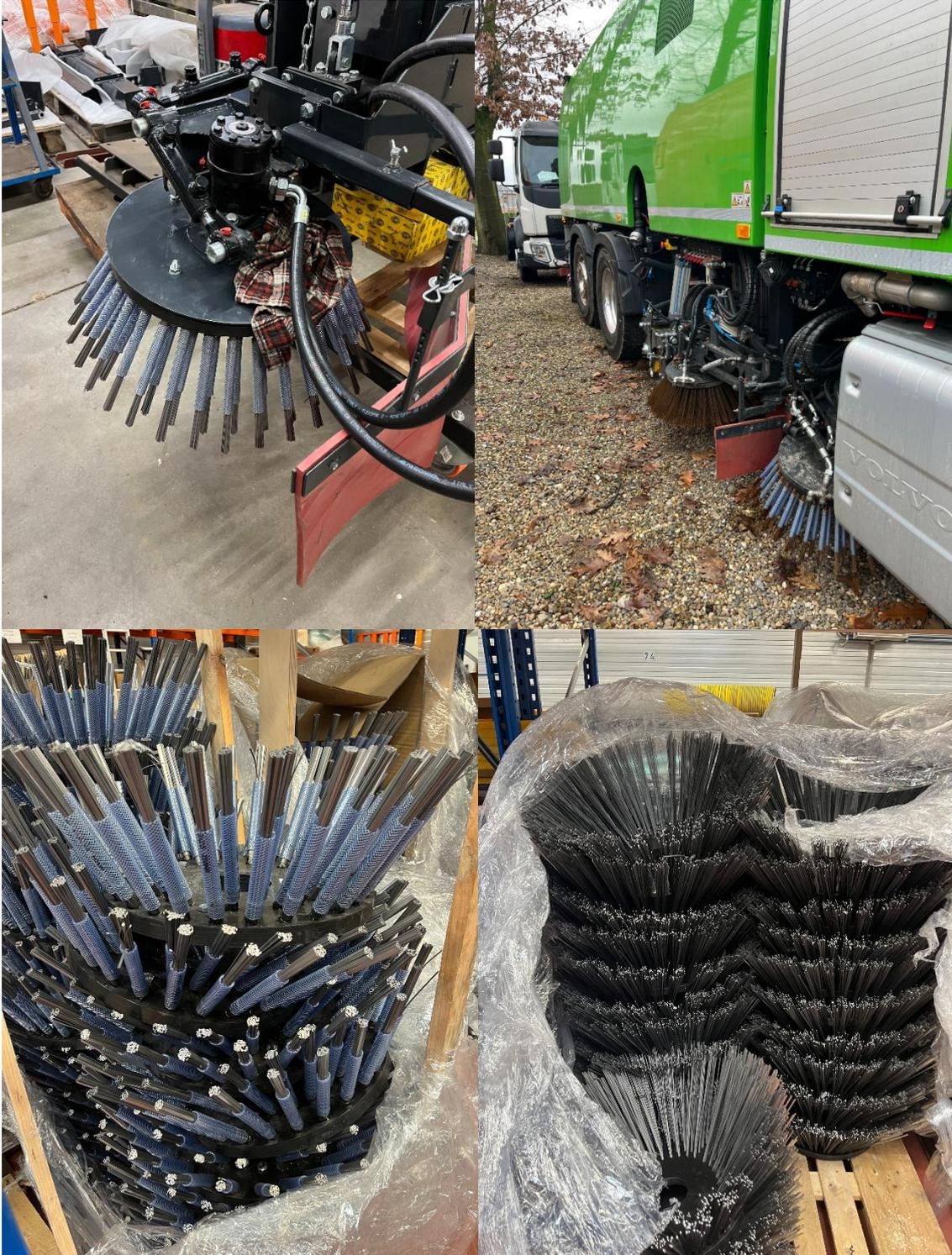
Figure 15 : au-dessus : photo d'un bras de désherbage articulé et d'un camion balayeuse avec une brosse de désherbage derrière les roues avant. Au-dessous : photo de brosse de désherbage à toron en acier à gauche et brosse de désherbage à "Touffettes" constituée
