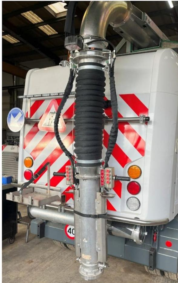
*Figure 19 : photo d'un bras d'aspiration pour poubelle enterrée monté sur une balayeuse Ravo*
