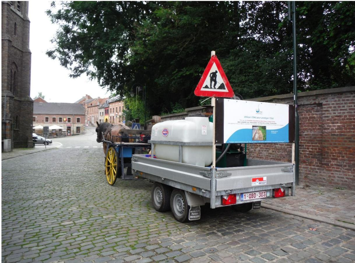
Figure 12 : photo d'un désherbeur mutualisé tracté par un cheval
